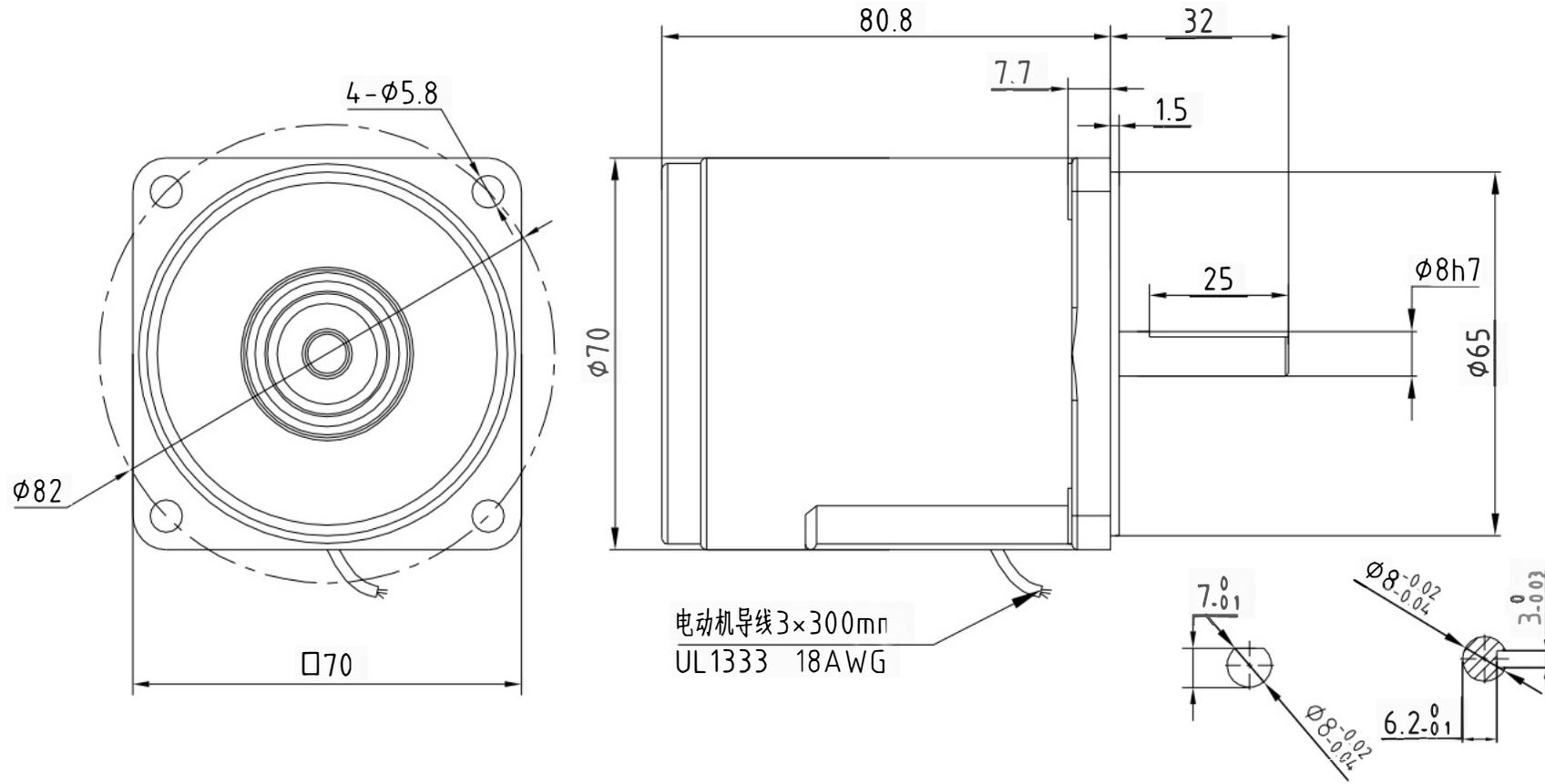
电动机导线  $3 \times 300\text{mm}$
